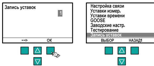
8 Если не нажимать кнопки в течение 1 мин, то произойдет автоматический переход терминала в дежурный режим. На дисплее будут индцироваться: текущие значения времени и даты.
